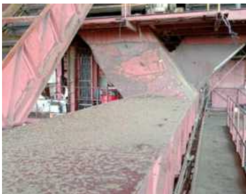
รูปที่ 5 ระบบสายพานลำเลียงเป็นระบบปิดครอบคลุมมิดชิด
