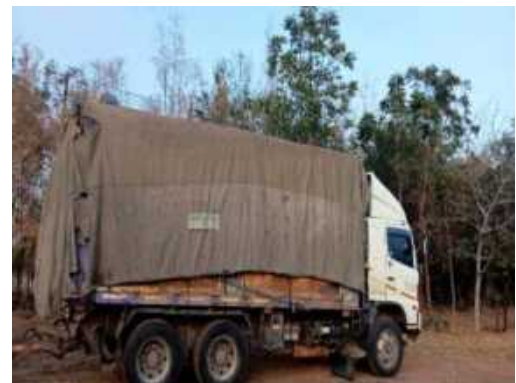
รูปที่ 19 รถขนเถ้าและกากตะกอนหม้อกรองปิดคลุมด้วยผ้าใบ
